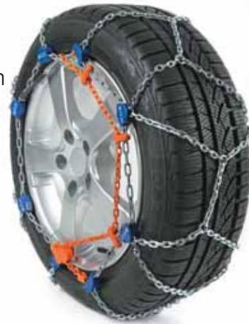
Weiterentwickelt wurde auch die bewährte Schneekette „compact Grip“: Sie bekam ein neues Laufnetz. Es sorgt bei den Ketten für eine verbesserte Freigängigkeit im Radhaus. Foto: *djd/RUD* Ketten
